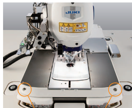
Viti per la regolazione della quantità di tensionatura del tessuto
