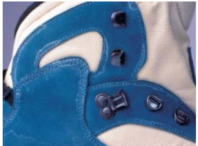
Effetti di filati ritorti per cuciture non sottoposti ad un corretto trattamento idrorepellente
