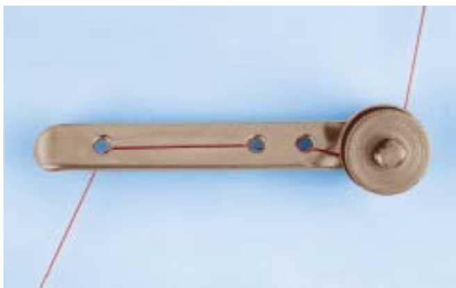
Esempio di corretta infilatatura
